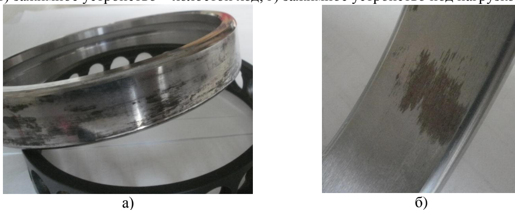
Рисунок 5. Повреждения подшипников шпинделя станка GLS-200M: а - следы проворота наружного кольца в корпусе; б - следы ослабления посадки по валу.
